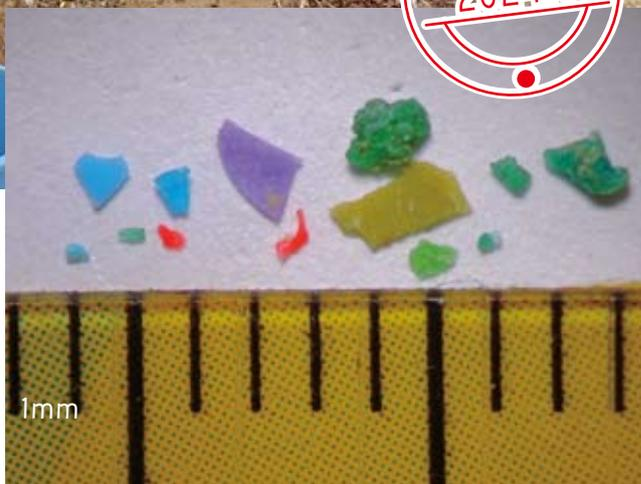
写真3: およそ1mm以下のマイクロプラスチック (1目盛りは1mmを表す)
